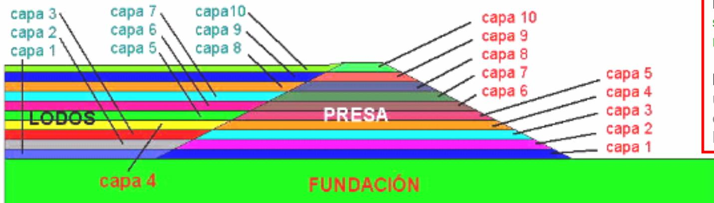
Fig. 2: Materiales y etapas de construcción de la presa y de llenado con lodos.
